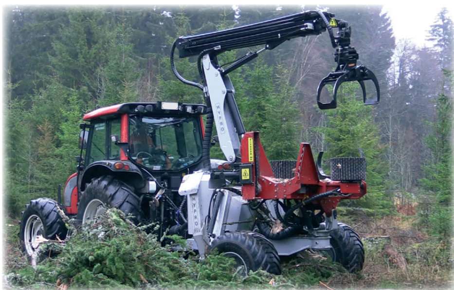
HYPRO 755 HB har hydrauliska stödben som standard.
