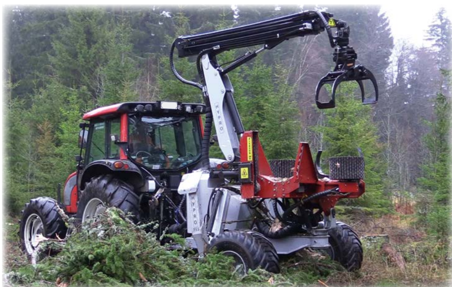
HYPRO 755 HB har hydrauliska stödben som standard.
