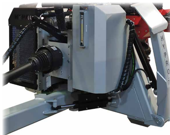
Ramstyrning +/- 25° med dubbla styrcylindrar
