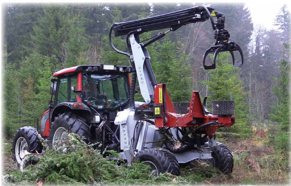
HYPRO 755 HB har hydrauliska stödben och stora 500/50-17 hjul som standard.
